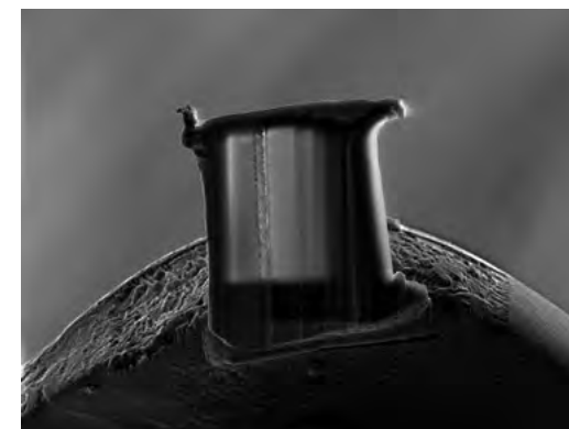
Lamelle TEM ultra fine présentant une zone d'interface sur du Si. La zone transparente présente une épaisseur homogène.
