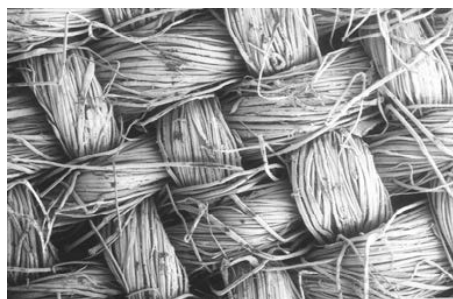
Le C2D produit d'excellentes images d'échantillons non revêtus en mode de pression variable, parfaitement adaptés aux comparaisons de fibres optiques.
