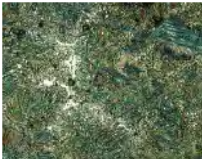
Image d'un échantillon de fonte ductile (ADI) obtenue à l'aide d'un microscope optique ; grandissement : 400:1
