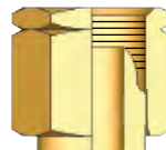
MG - taroudage femelle avec portée conique, étanchéité métal
