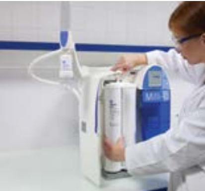
Remplacement de la cartouche de polissage QPAK®
