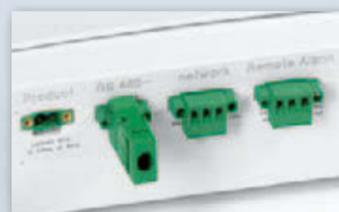
Les appareils de laboratoire sont équipés d'un contact sans potentiel pour **relayer l'alarme** à un système externe d'avertissement à distance.
