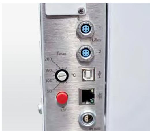
Interfaces Ethernet et USB et raccord Pt100
