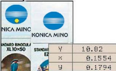
On mesure le logo bleu. La réflectance spectrale est à peu près la même que celle de l'exemple B. Mais, si nous regardons de plus près, nous constatons que la réflectance spectrale dans la zone de longueur d'onde supérieure à 600nm est encore plus faible que dans B. Ici, nous avons un bleu sensiblement plus foncé.
