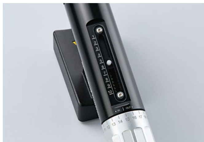
CellTram 4m Air : La sensibilité à la pression pour diverses applications peut être ajustée par différentes positions du piston
